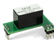
MMBL-BRAKE Könnyen beilleszthető modul az MC91BL-SC vezérlőkártyába a motor megfordíthatóságának csökkentése érdekében
